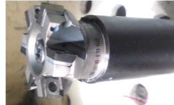
粗铣面 铣刀盘：MF90-63.6-SW1304-A22 刀片：SXGM1304PDEF-AL MN055
