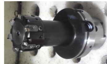
精铣面 精铣刀盘：KSCM63R06CAB22 PCD刀夹：WWDJ-PCD-RZ
